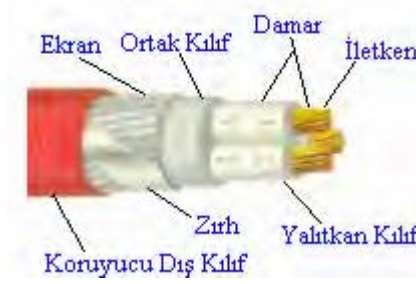
Şekil 2.1 YVŞV(NYFGbY) Kablolsunun iç yapısı (siemens)
